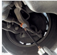
Atbrīvojiet stūres mehānisma savienojumus
