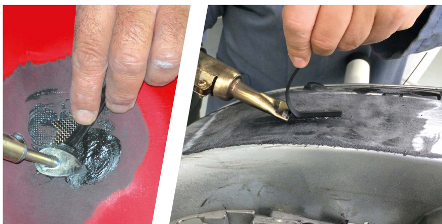
Plastikinių litavimo strypų naudojimo pavyzdžiai
